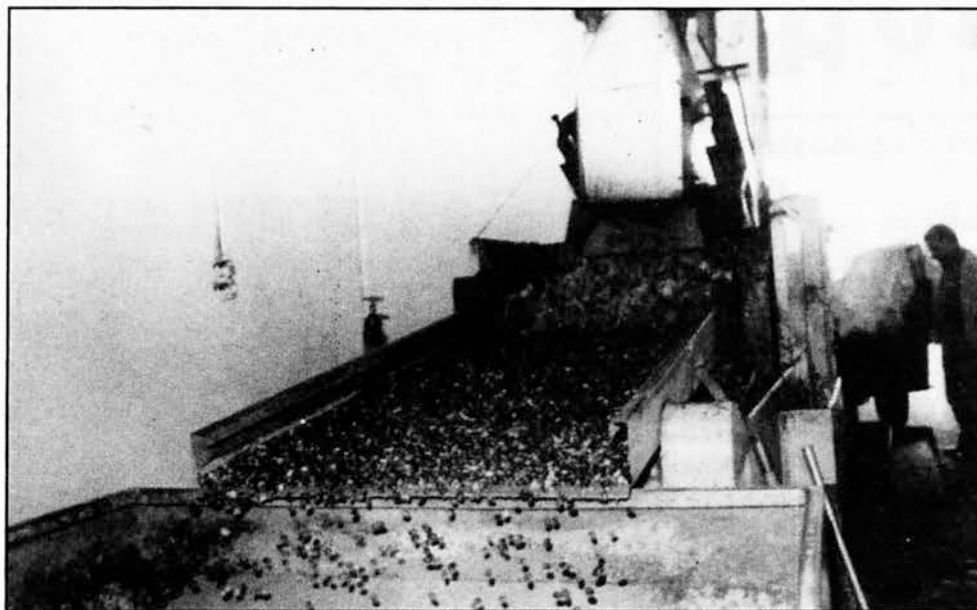
Μηχάνημα πλύσεως του ελαιοκάρπου σε λειτουργία
